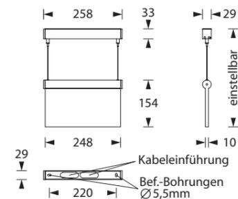
**Gehäuseausführung / Casing design / Configuration logement**
