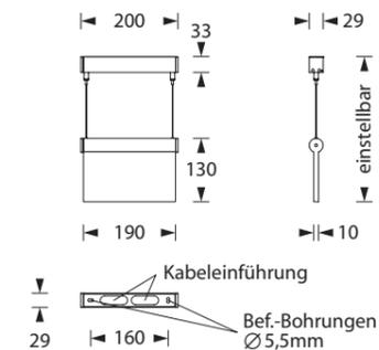
**Gehäuseausführung / Casing design / Configuration logement**
