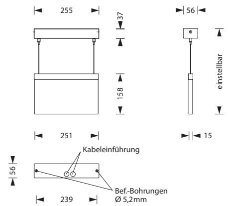
**Gehäuseausführung / Casing design / Configuration logement**
