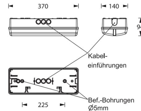
Gehäuseausführung / Casing design / Configuration logement
