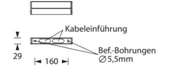
**Deckenmontage / Ceiling mounting / Montage au plafond**
