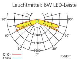
Lampenlichtstrom Not/Netz: 580lm/580lm – Nennbetriebsdauer: 1h/3h
