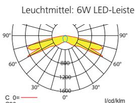
Lampenlichtstrom Not/Netz: 320m/580lm – Nennbetriebsdauer: 8h
