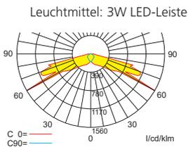
Lampenlichtstrom Not/Netz: 350lm/350lm – Nennbetriebsdauer: 1h/3h
