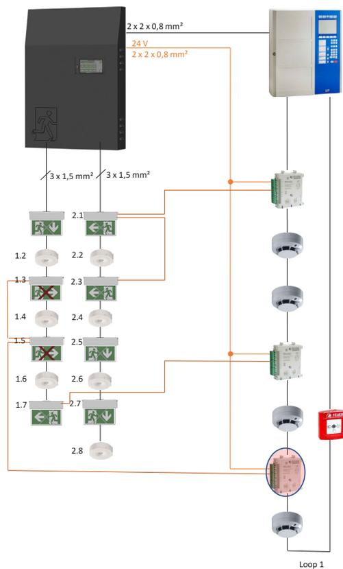
**Anschlusschema (Beispiel): RIVA-Leuchten in Verbindung mit Brandmeldeanlage und CPS/LPS**
