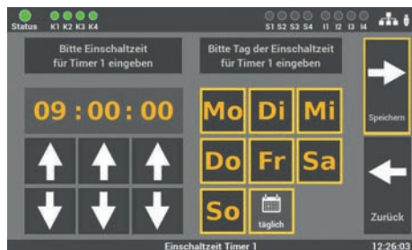
Abb. 99: Maske „Zeitschaltuhren – Einschaltzeit“
