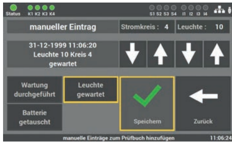
Abb. 67: Maske „Manuelle Dokumentation – Wartung Leuchten“
